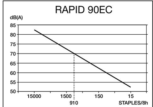
Equivalent geluidsniveau dB(A) bij maximum capaciteit en slagsterkte.
