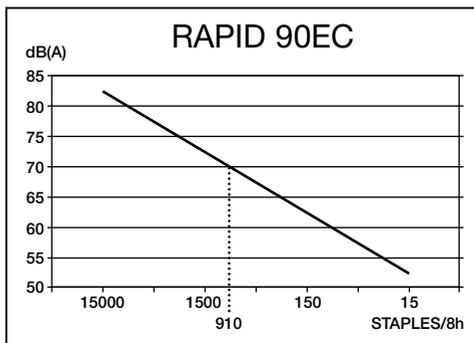
Эквивалентен уровню шума в дБ(А) при максимальной мощности. Например, степлирование 910 скобами в течение 8 часов создает шумовой фон в 70 дБ(А) (90ЕС). Измерение шума сделано в соответствии с ISO 7779 и дополнением "Электрические степлеры: Код тестирования шума".
