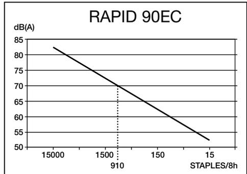
Ekvivalent ljudnivå dB(A) vid maximal kapacitet och slagstyrka.
