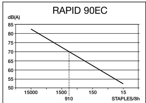
Nível sonoro equivalente dB(A) a uma capacidade e força de impacto máximos.
