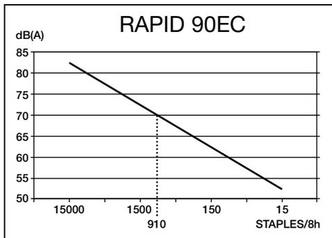
Entsprechender Geräuschpegel dB(A) bei maximaler Kapazität und Schlagstärke.
