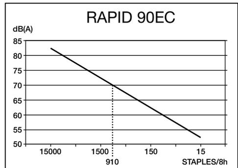
Rumorosità equivalente in dB(A) alla capacità e con la forza di battuta massime.
